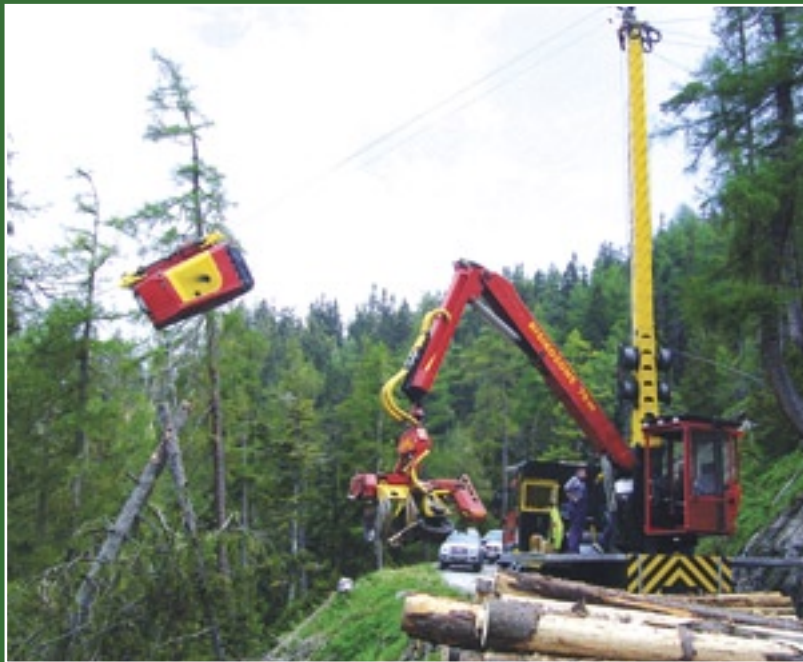
Kombiseilgerät: Bäume aus dem Wald schaffen, auf- bereiten und für den Transport bereitstel- len - alles in einem Gerät
